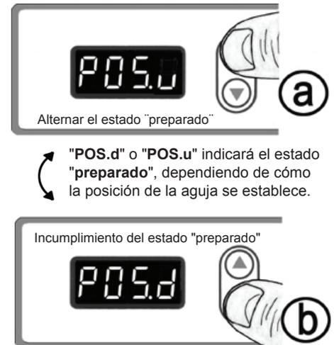
When positioner sensor is set correctly to the **UP** position and you stop sewing, the needle will stop at the **UP** position. Si a continuación, pones el talón al pedal, el motor girará para poner la aguja en la posición **DOWN**.
